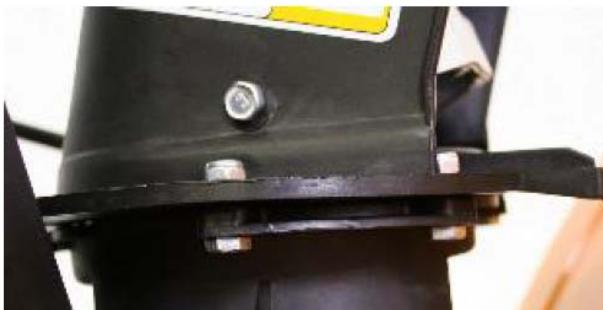
Установите выбрасыватель, как показано на рисунке. Добавьте смазку между пластиковыми деталями для снижения трения.
